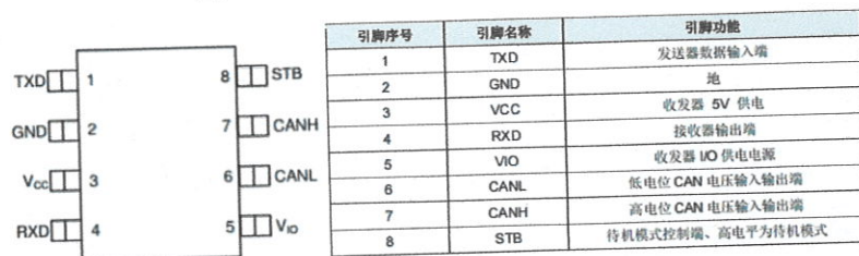
图 2. ASM1042S2S 引脚分布图
