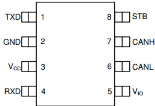
图 1 FD CAN 芯片引脚分布图
