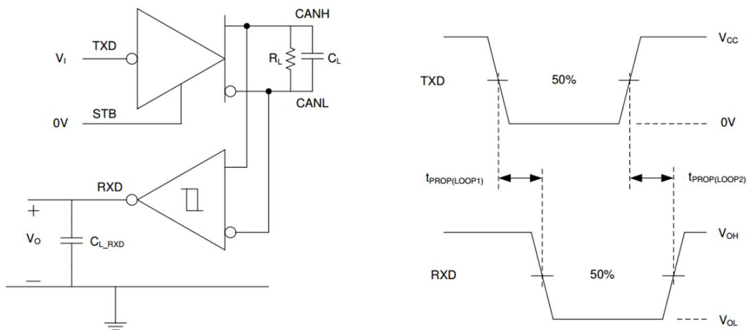
图 5 环路延时时间仿真电路与时序图
