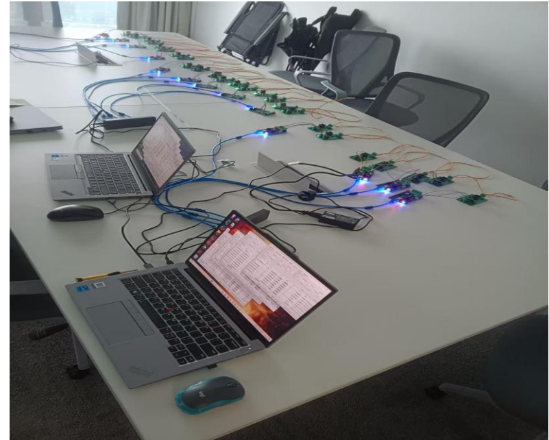
图 CANFD 芯片 25 节点测试环境
