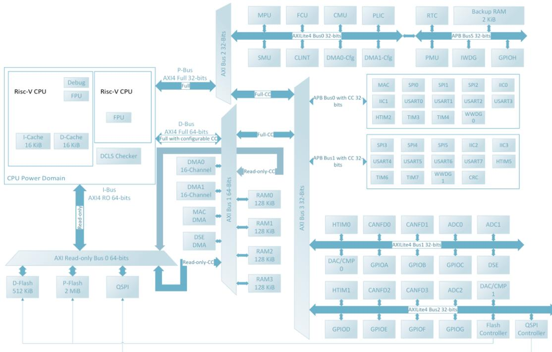
MCU 的总线的 AXI Crossbar 是一个总线矩阵，用于互联 CPU 内核与系统存储器及外设模块的访问（读写）。
