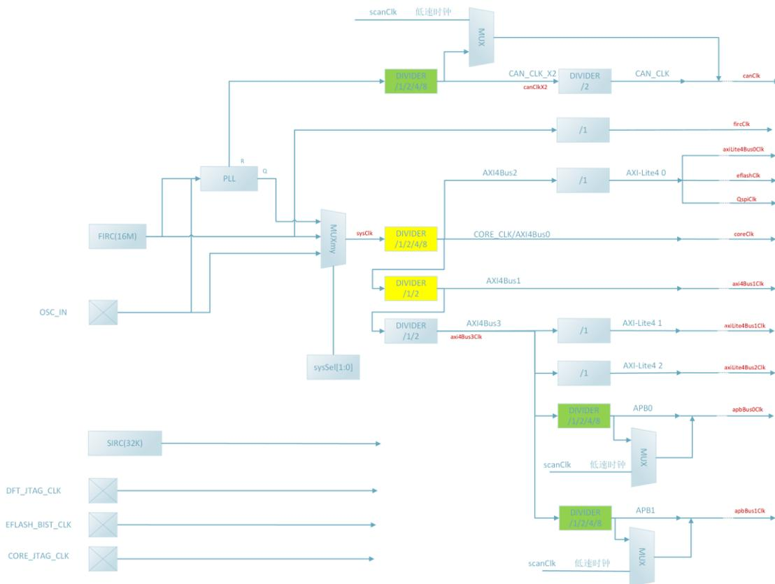
时钟管理模块为 MCU 提供时钟选择。包括快速内部时钟（FIRC）、内部慢速时钟（SIRC）、外部晶振（OSC）和 PLL 作为时钟源。其中 PLL 的参考时钟可以来源于 FIRC，也可以来源于 OSC。
